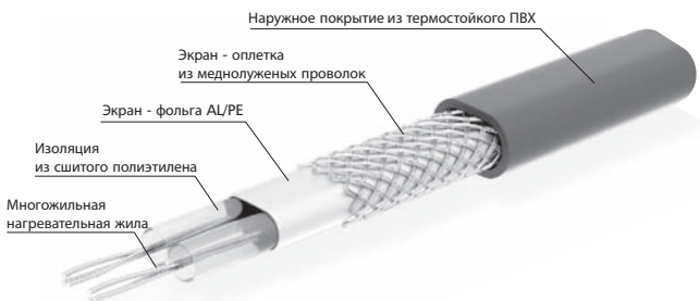
Конструкция нагревательного мата ELEKTRA SnowTec®
